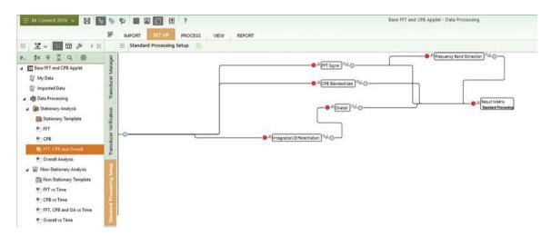
对于每个设置,都会预先配置一整套实时监控器,并预定义一个目标流程(分析)链 – 为您开始分析做好准备。如果需要,您可以根据自己的测试规范调整显示器参数和分析属性。准备就绪后,使用位于监视器中的简单记录仪记录数据。
