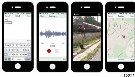
Sobald eine Verbindung zum Analysator hergestellt ist, können Sie Ihre Messungen aus sicherer Entfernung starten, stoppen und pausieren. Während der Geräuschmessung wird das momentane LAF-Profil auf der Feld-App angezeigt. Bei der Schwingungsmessung erscheint das Profil „Fast Inst“ (Schnell, momentan).
